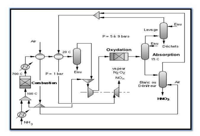
Figure 2. Schéma du procédé de fabrication de l'acide nitrique
