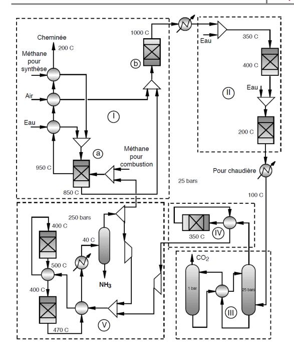
Figure 1. Schéma représentant le procédé de fabrication de l'ammoniac.
