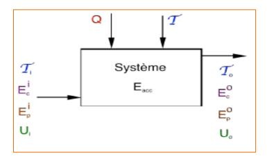
**Figure3**. Représentation de l'énergie accumulée par le système.
