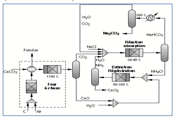
Figure 5. Schéma du procédés de fabrication de la soude (procédé solvay).
