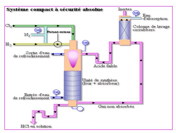
**Figure4.** Schéma d'un dispositif industriel de synthèse direct d'acide chlorhydrique (document carbone –Loraine).
