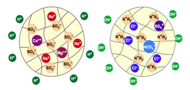
Figure6. Les billes de résine sont saturées. Des ions H<sup>+</sup> et OH<sup>-</sup> ont été relâchés dans l'eau
