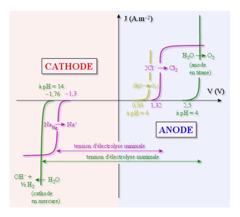
**Figure 1.** Diagramme intensité –potentiel de l'électrolyse du chlore de sodium sur cathode au mercure.
