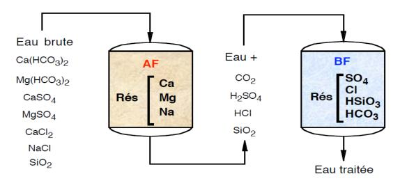
Figure 9. Déminéralisation sur résine échangeuse d'ions.
