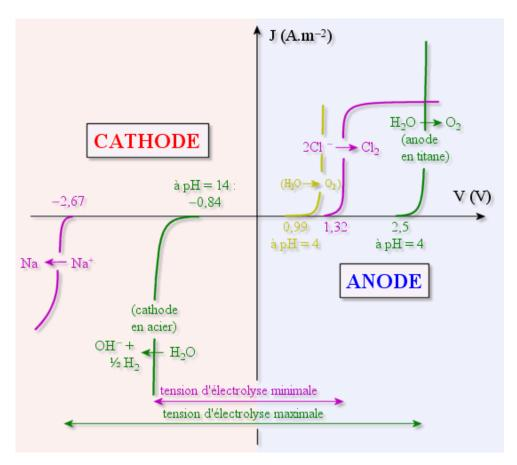
**Figure 2.** Diagramme intensité –potentiel de l'électrolyse du chlore de sodium sur cathode en acier.
