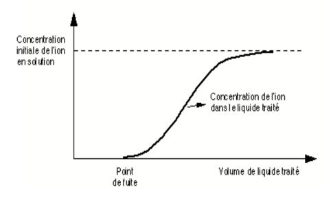
**Figure 8.** Suivi d'un procédé de déminéralisation par résine échangeuse d'ions
