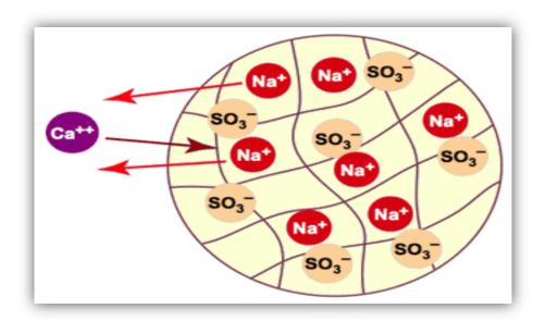
Figure 4. Adoucissement (échange sodium) dans une bille de résine.
