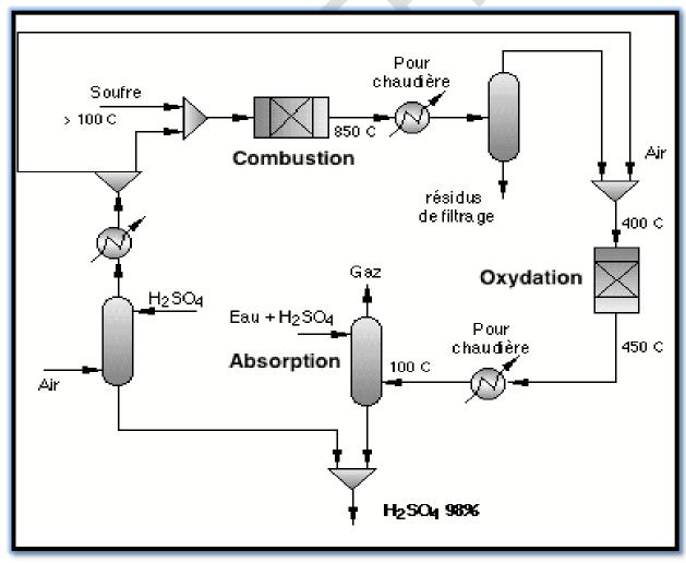
Schéma du procédé de fabrication de l'acide sulfurique.
