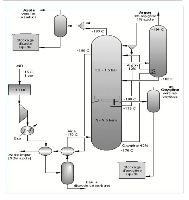
Figure 1. Schéma du procédé de rectification de l'air.
